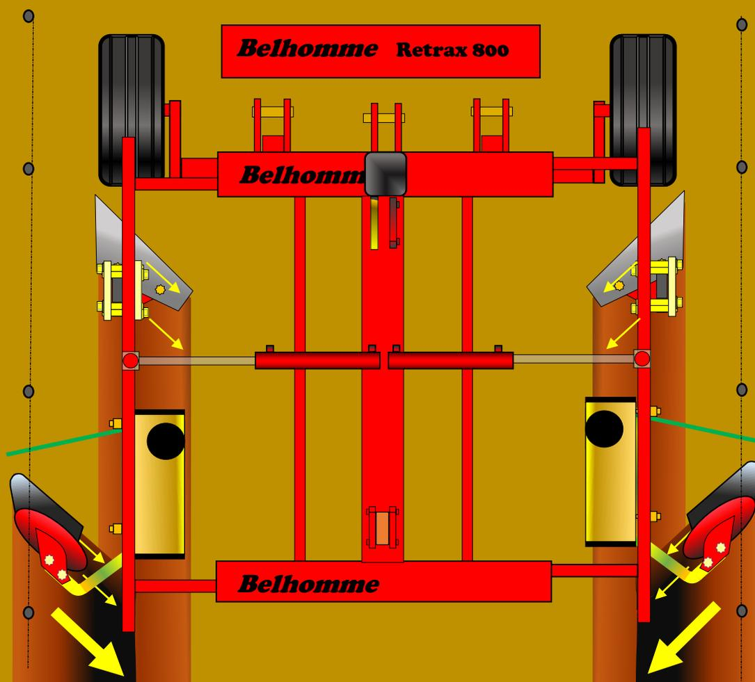
**Versoirs utilisés pour le débattage , les Dk Bel 1 montés sur les REFLEX sont utilisés pour extraire la terre qui forme butte sous le rang . Le pivotement du bras se produit dès que le palpeur détecte la plante . L'extrême réactivité du palpeur permet un travail propre et précis de la périphérie proche du plant .Vitesse de travail 2 à 4 km/h.**
